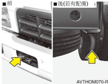
當無專業拖吊公司拖吊車輛可用時，可將拖車鏈條或索具勾住車底前和後側下方的拖吊鉤上。不要在未鋪柏油的路面上以此種方式拖吊您的車輛。因為這將可能會使車輛嚴重受損。
