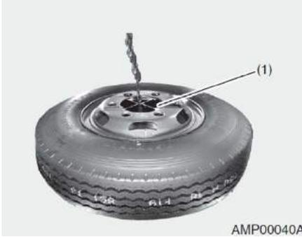
2. 安裝時，將鋼圈的凸出面朝上放置，將掛鉤(1)安裝到鋼圈的孔，並順時針方向轉動搖轉把手，升起鏈條。
