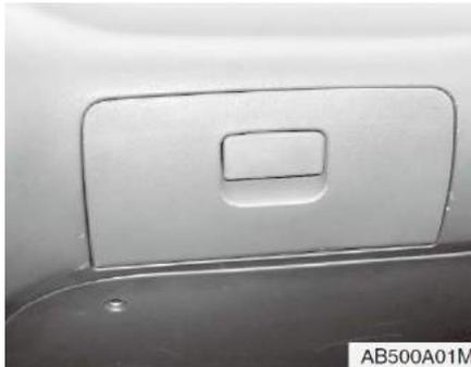
拉動手套箱釋放桿可開啟手套箱。
