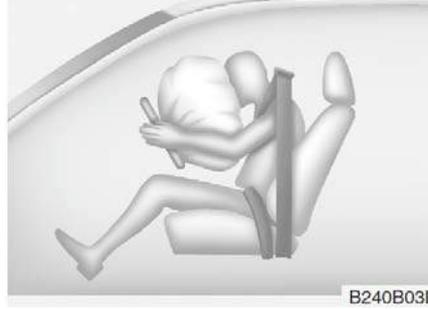
完全充氣的氣囊搭配正確的安全帶穿戴，可以減緩駕駛與乘客往前移動，減少頭部與胸部撞擊的傷害。
