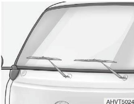
雨刷片應時常小心檢查並清除路面或其他殘屑。清除雨刷片和雨刷臂時，使用乾淨的海綿或布，沾些中性的肥皂或清潔劑之水溶液輕輕拭擦。如果雨刷刷動時有線紋或髒污持續留在玻璃上時，我們建議您使用授權的 HYUNDAI 經銷商的零件來更換。
